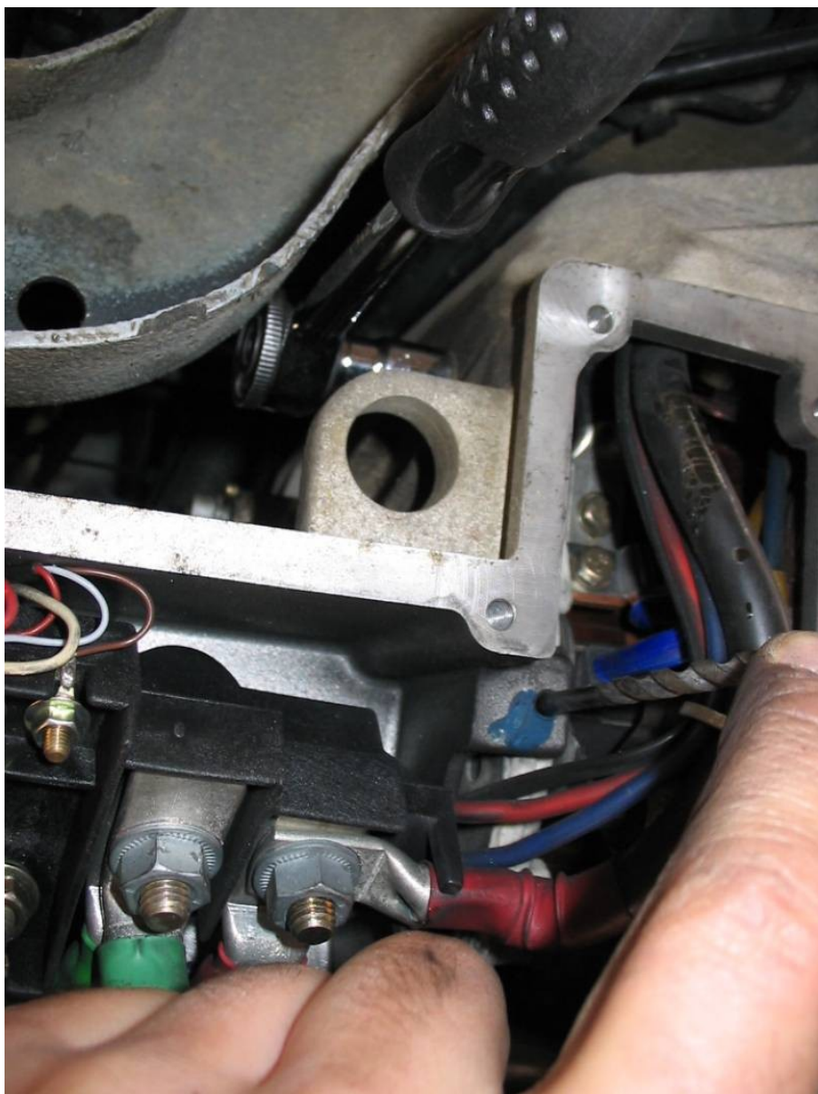
Vrták slouží pro nastavení polohy držáku uhlíků po skončení výměny.
